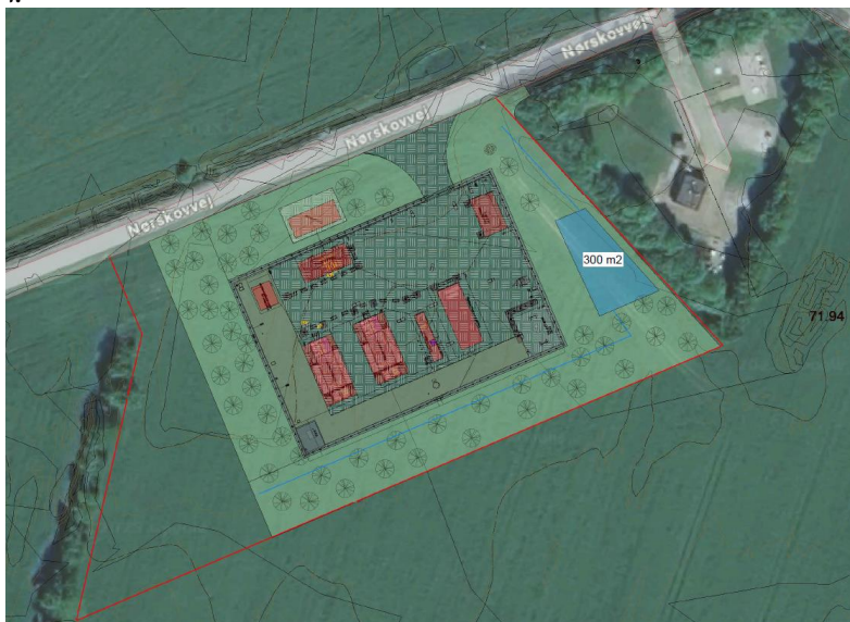
Figur1: Luftfoto med illustration af anlæggets placering langs Nørskovvej og sydvest for eksisterende M/R station. Den røde linje markerer hele området inklusiv midlertidigt byggepladsareal.
