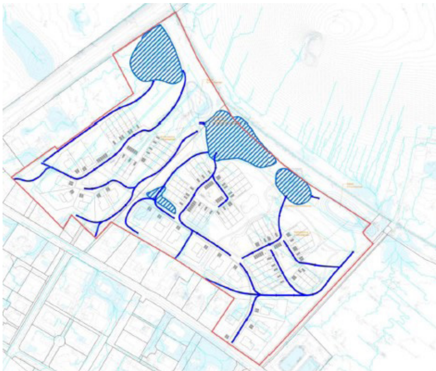
Figur 5: Forslag til skybrudshåndtering inden for lokalplanområdet mellem bebyggelse og vandløb. Mørkeblå streger viser princip for strømningsveje og lavninger, lys blå streger viser de eksisterende strømningsveje og lavninger. Illustration fra Vandhåndteringsnotat
