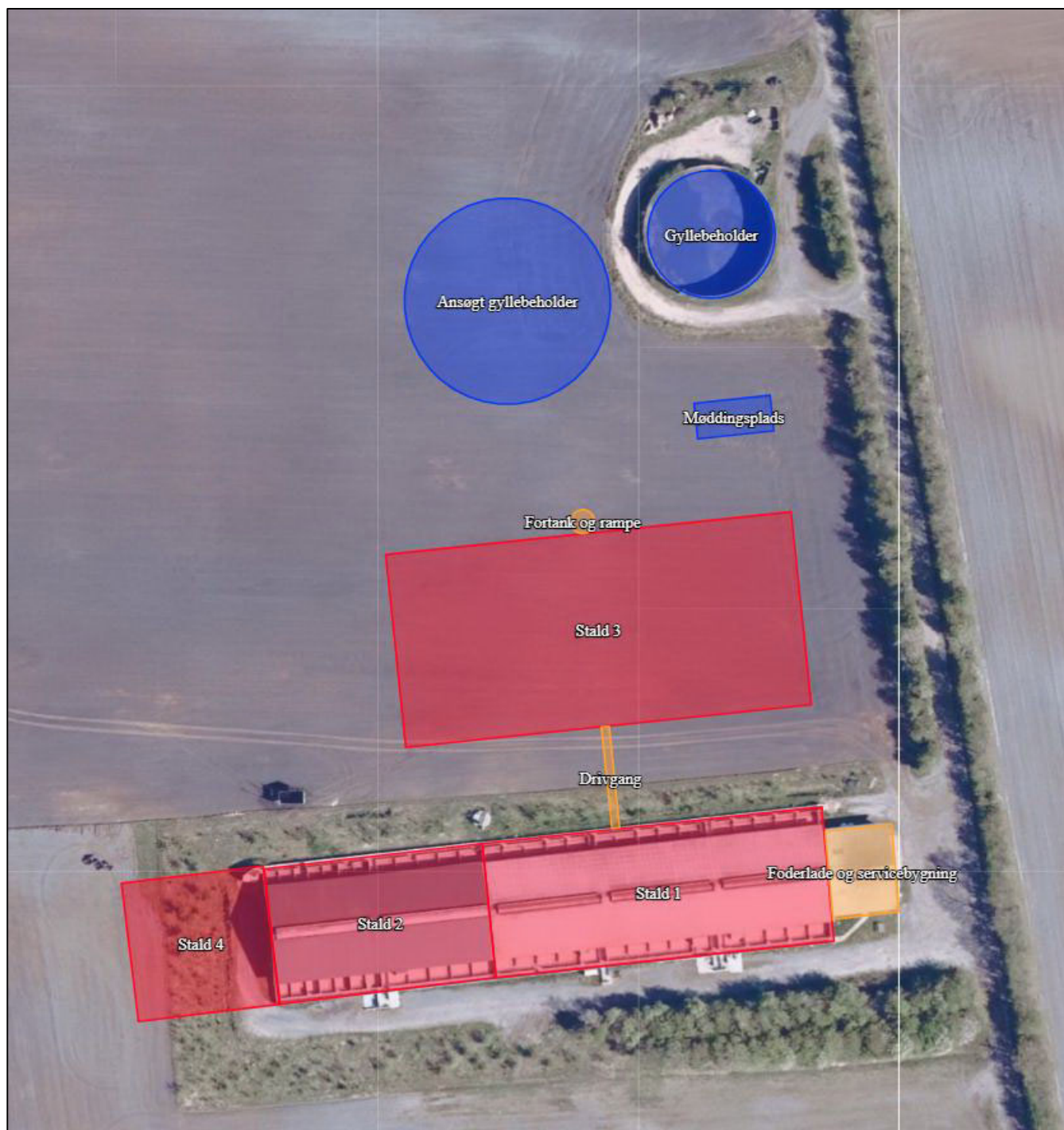
Figur 1. Oversigtstegning der viser ejendommens staldanlæg
