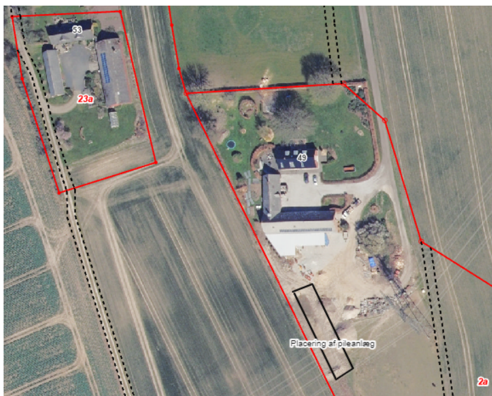
Placering af fælles pileanlæg til rensning af husspildevand fra de 2 ejendomme
