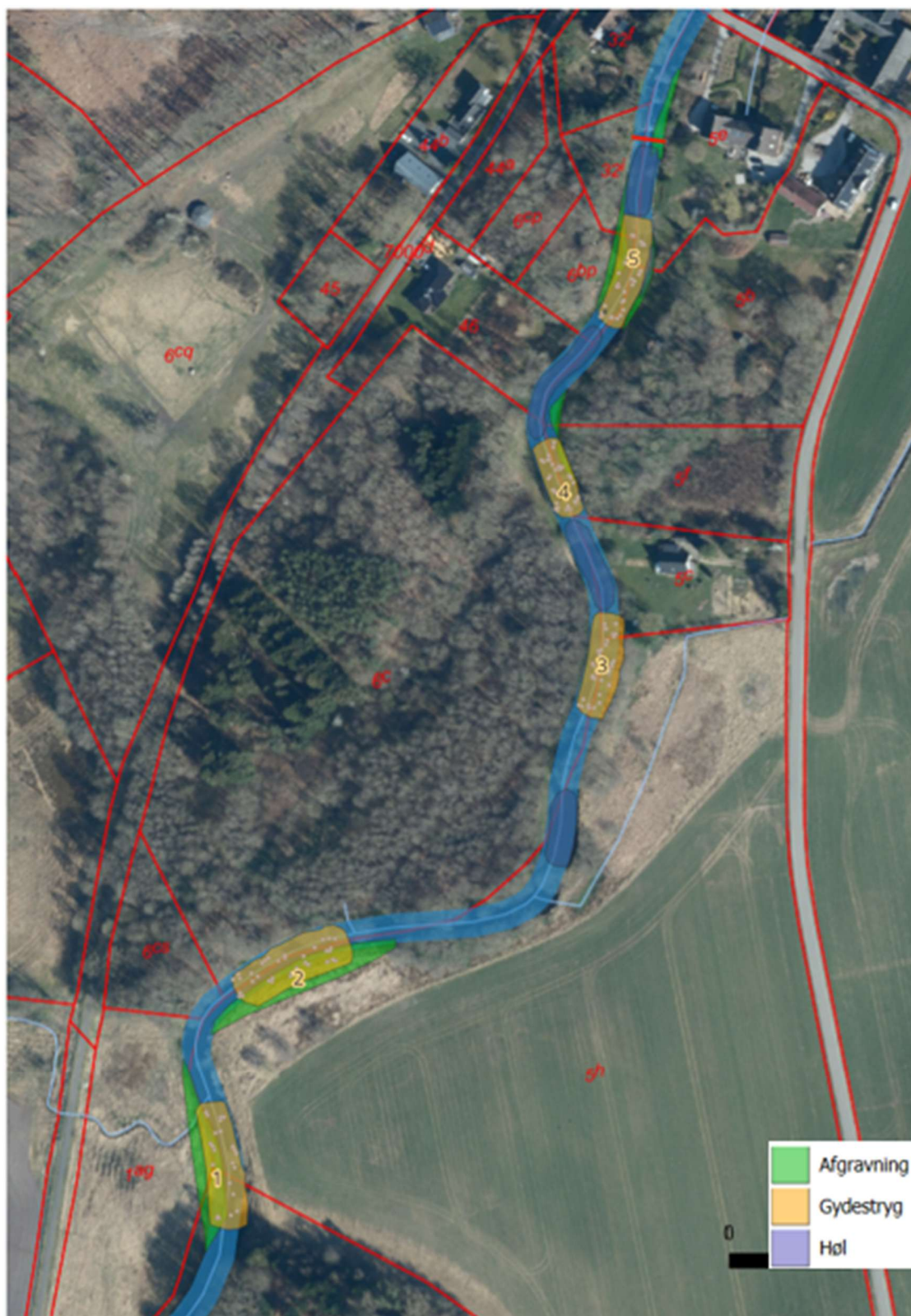
Figur 7 På ovenstående kort kan ses, hvor der placeres gydebanker, høl og afgravning af brink.
