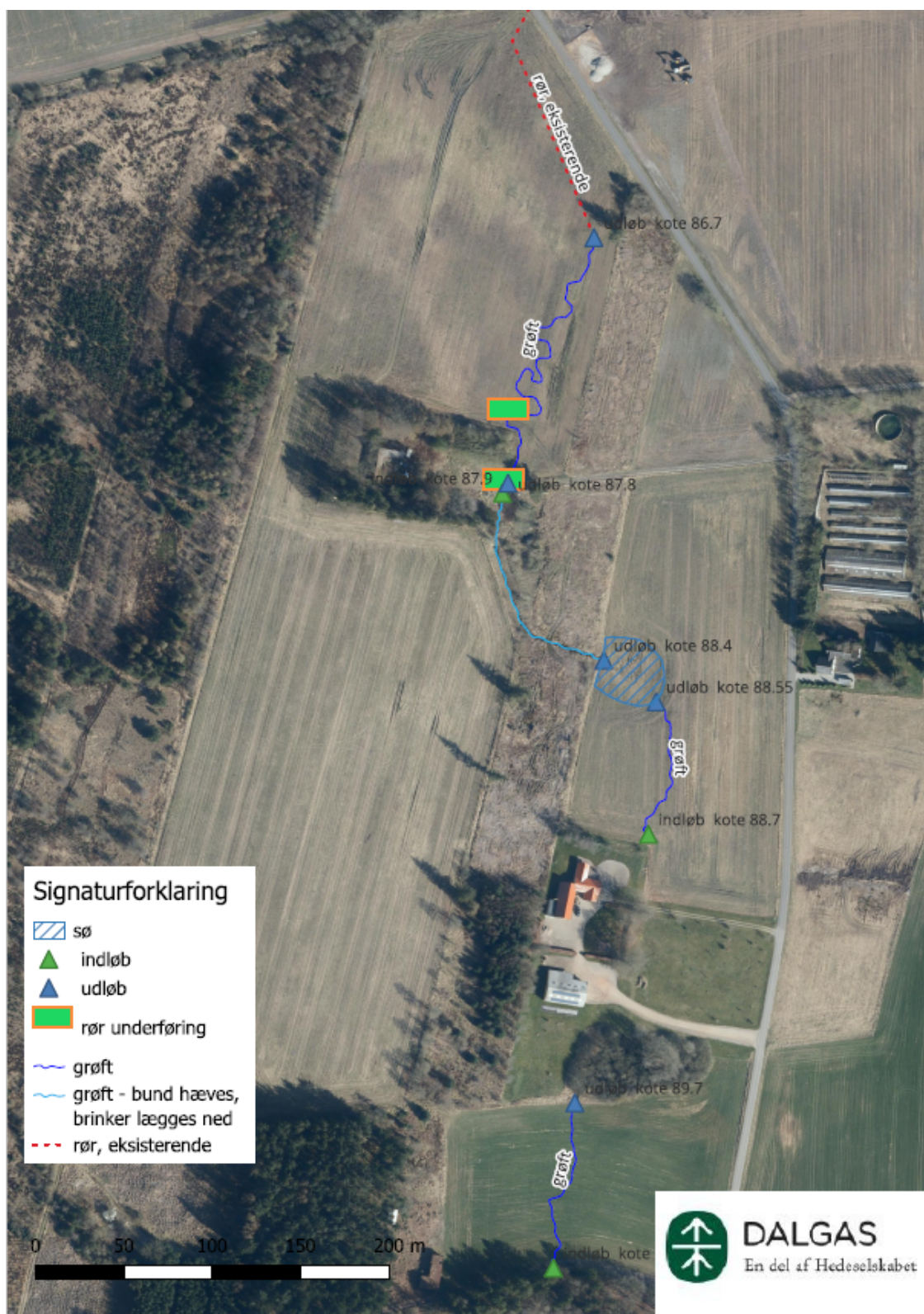
Figur 2: Kortbilag over vandløbets forløb efter åbning, ind-og udløb markeret med koter, samt placering for rørunderføring.
