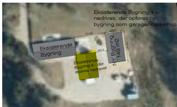
Figur 1 Bygning 4, som skal nedrives.
