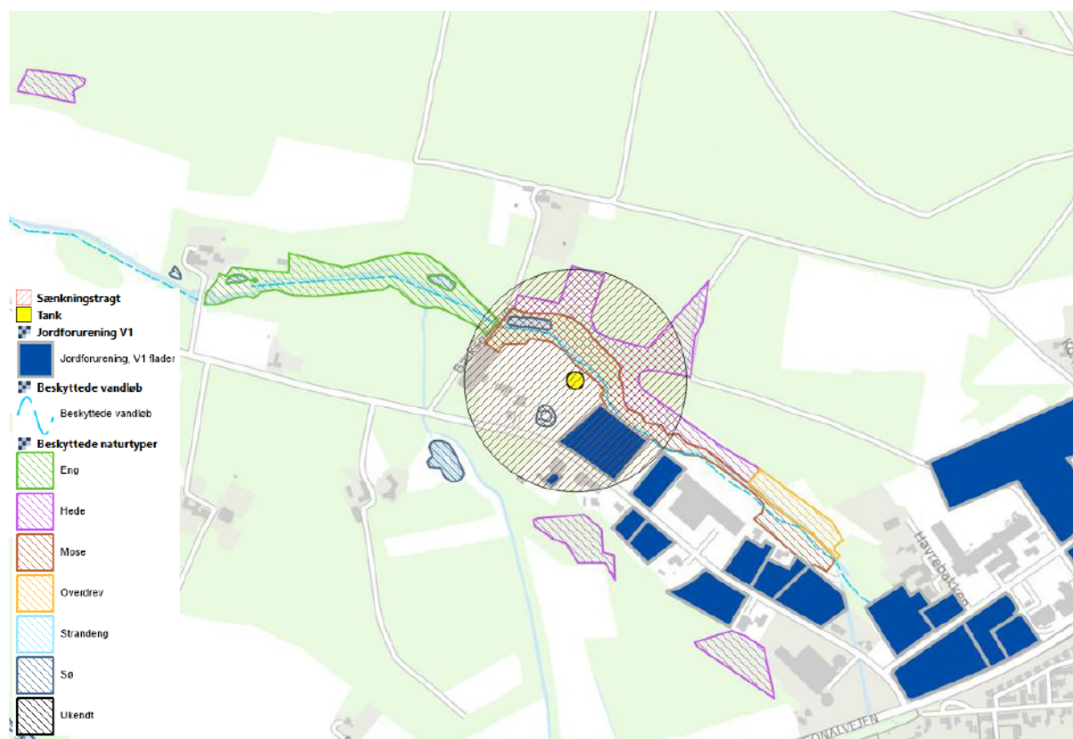
Figur 2: Udbredelse af sænkningstragten ved en grundvandssænkning med spuns.
