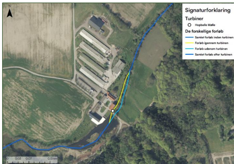
Figur 15: Vandløbets forløb ved den opstemmede sø, hvor det ene forløb ledes igennem turbinen ved Hopballe Mølle, og det andet forløb løber udenom, hvorefter de samles længere nedstrøms /29/.
