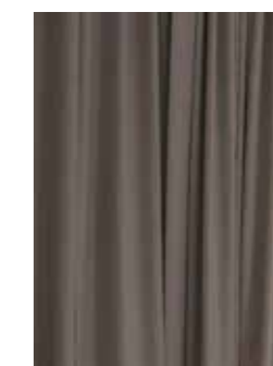
TUNGE TEKSTILER BRUGES TIL AT REGULERE AKUSTIKKEN
