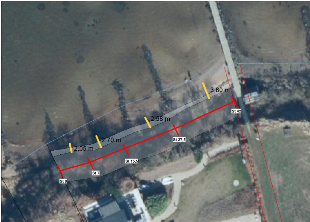
Figur 11 viser afstand fra synglig stenkastning til kote 0 (strand) ved etablering af den ansøgte stenkastning
