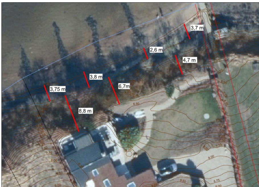
Figur 2 viser bredde af skrænt og strand til kote 0,25 m over dvr90 på ud fra kotekort fra 24. juli 2024 (statens højdedata)
