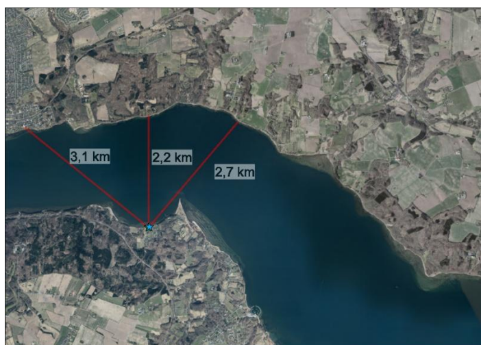
Figur 6 viser Vigen 80's eksponering for bølgepåvirkning (fra nordvest til nordøst) inde i en fjord med relativt lille frit træk til modsatte bred og dermed begrænset mulighed for bølgegenerering
