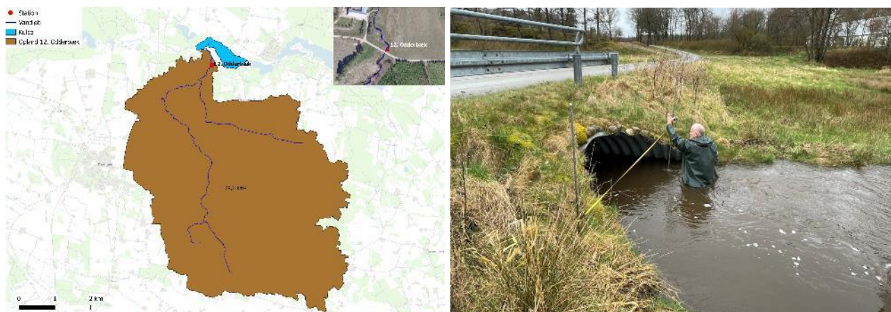
Figur 12.3: Tv: Oplandsareal til 12. Oddebæk. Th: Måling af vandføring i 12. Oddebæk
