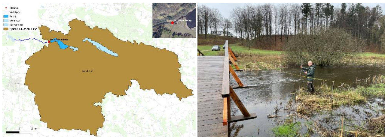
Figur 12.5: Tv: Oplandsareal til 14. Afløb fra Kulsø. Th: Måling af vandføring i 14. Afløb fra Kulsø.
