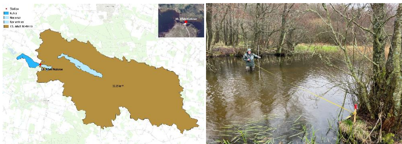
Figur 12.1: Tv: Oplandareal til 10. afløb fra Nedersø. Th: Måling af vandføring i 10. afløb fra Nedersø.
