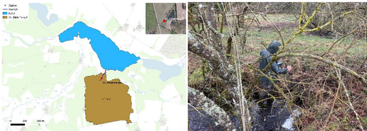
Figur 12.2: Tv: Oplandsareal til 11. Tilløb fra syd. Th: Måling af vandføring i 11. tilløb fra syd
