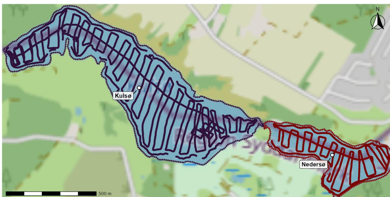
Figur 2.1: Transekter for sonaropmålinger i Nedersø og Kulsø. Transekterne er angivet med punkter, der dog er placeret så tæt at de overlapper og ligner linjer. Der er indsat punkter langs søernes breder for hver 20m med dybden 0m som delineerer bredzonen i interpoleringen. Kort produceret i R (version 4.5.3).
