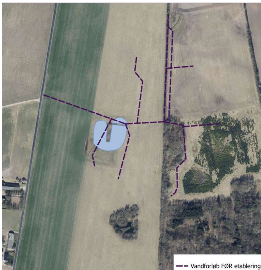
Figur 5.: Drænforløb før etablering.
