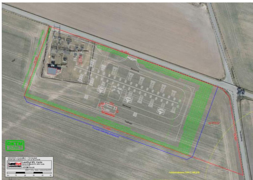
Fig 1: luftfoto viser udvidet transformerstation. Den gule linjer mød øst viser 100 meters fortidsbeskyttelseslinje.
