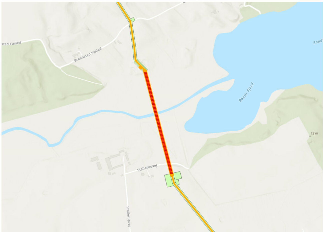
Figur 2: Kortudsnit af kabelledningens tracé (orange linje) samt underboringens placering (rød linje).
